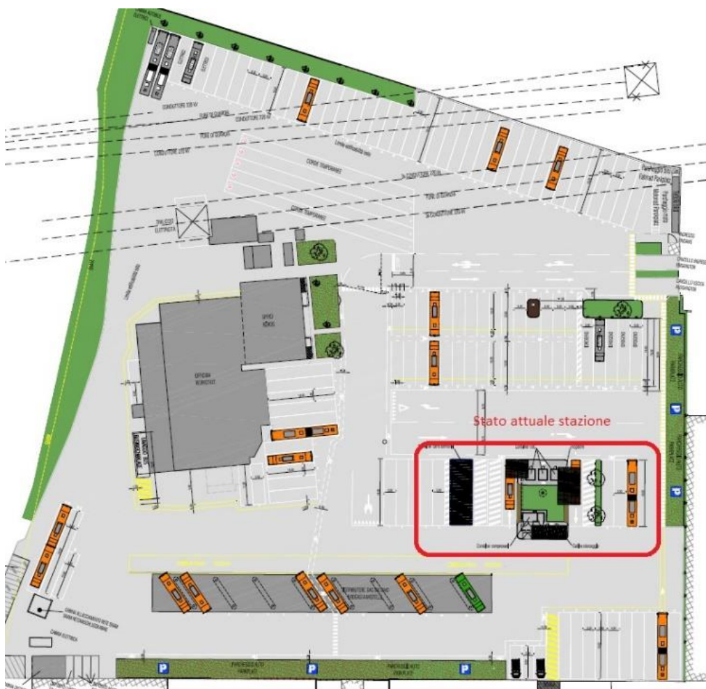
Figura 1- Planimetria del deposito con individuazione dell'area dell'impianto di rifornimento idrogeno
